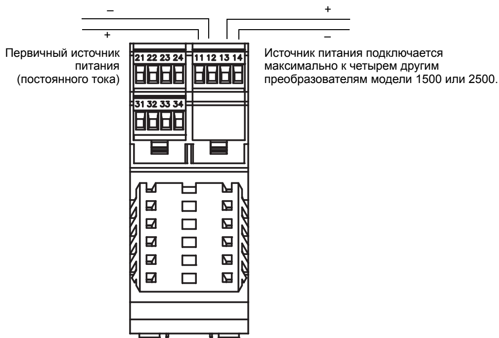
Рисунок 2-6 Подключение источника питания преобразователя
