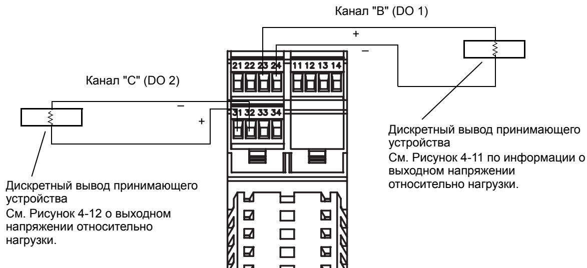
Рисунок 4-7 Дискретная выводная проводка – внешний источник питания
