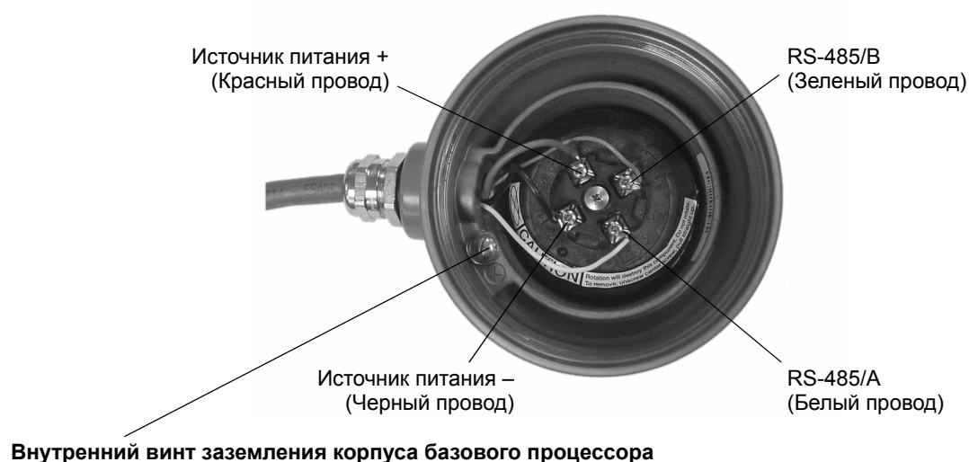
Рисунок 3-7 Подключение проводки на базовом процессоре
