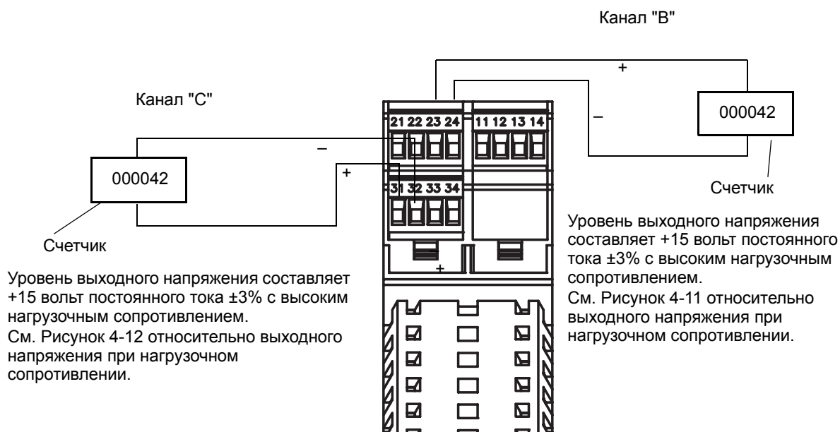
Рисунок 4-4 Проводка частотного выхода – внутренний источник питания
