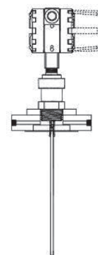
Рис. 6. Rosemount серий 3300/5300 с промывочным/продувочным соединением.
