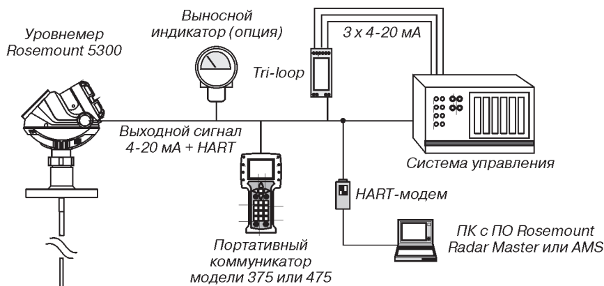
Рис.23. Интеграция в систему с использованием HART-протокола.
