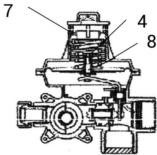
Регулятор двухступенчатый, первая ступень сбалансирована, позволяет достигать высокой точности выходного давления, в том числе с разным входящим давлением.
